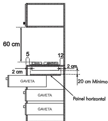
NOTA: - Coloque o cordão selador nas bordas do alojamento entre a mesa do fogão e a superfície do móvel;
